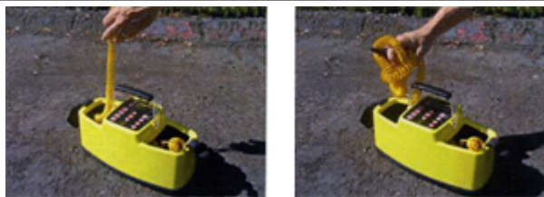
Рисунок 20: Хранение шнуров: правильный (слева) и неправильный (справа) способ
